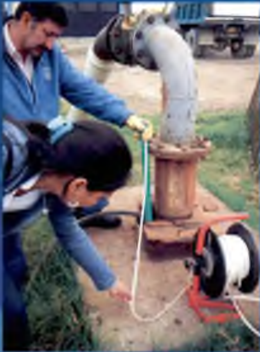
Monitoreo de niveles piezométricos
