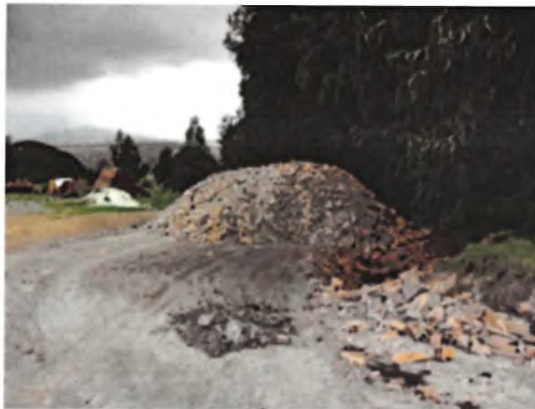
Foto 5. Almacenamiento temporal de chamote y cenizas para su posterior reutilización Sologres cerámicas LTDA Mochuelo bajo, Bogotá D.C
